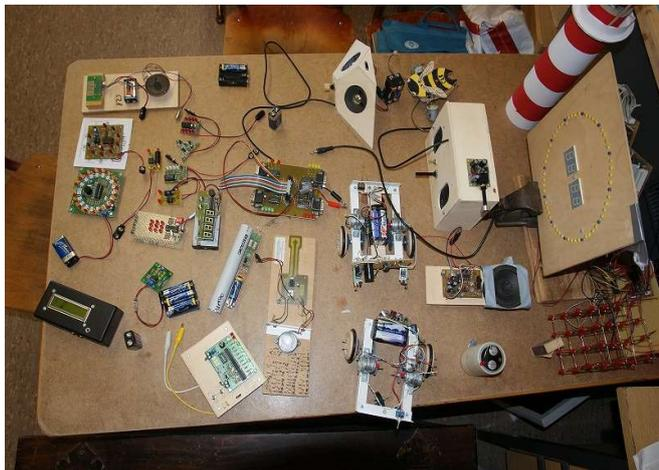
Foto 1 Mustertisch mit vielen Bausaetzen, links einfache Bausaetze (Blinker und Spiele) in der Mitte Taschenlampe, Morsetaste und Messgeraete, rechts Roboter, UKW-Radio und Smartphone-Verstaerker, ganz rechts Cube, C28-Uhr und ein Leuchtturm
