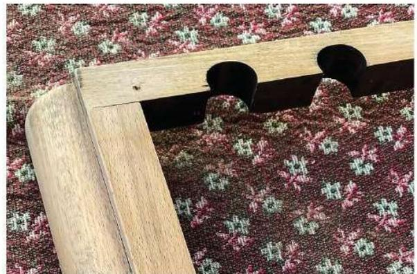
später mit ganz feinem (320er). Bis, ja bis letztlich das Gehäuse ganz von der 80 Jahre alten Lackschicht befreit war und wieder in originalem furnierten Zustand eine ganz matte Optik zeigte. Gott sei Dank war das Furnier so dick, dass es an keiner Stelle im Laufe des Schleifvorgangs zu dünn wurde und das Gehäuseholz zum Vorschein kam.
