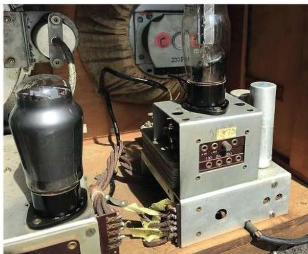
Beim Blick ins Innere zeigte sich ein Chassis ohne den geringsten Rostansatz, lediglich mit Staub bedeckt. Der Verbindungsstrang vom „Netztrafo-Chassis“ zum „Radio-Chassis“, der aus braunen stoffummantelten Drähten besteht, zeigte, daß auch hier schon mal gebastelt wurde, jedoch mehr schlecht als recht, denn die Anschlussseite am Trafo-Teil war ausgefranst und hielt wohl nur noch an hauchdünnen Drähten.
