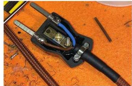
Problematik bei einem stoffummantelten Kabel ist das Ausfransen an den Enden bzw. beim Abisolieren. Mit einem Stückchen Tesafilm kann man dies leicht verhindern. Noch schöner und gelungener sieht es dann zum Schluss aus, wenn man ein passendes Stück Schrumpfschlauch verwendet und damit das Kabel abschließt, sowohl an Geräteseite als auch an Steckerseite. Somit konnte der alte Schweizer Stecker auch hier wieder verwendet werden.
