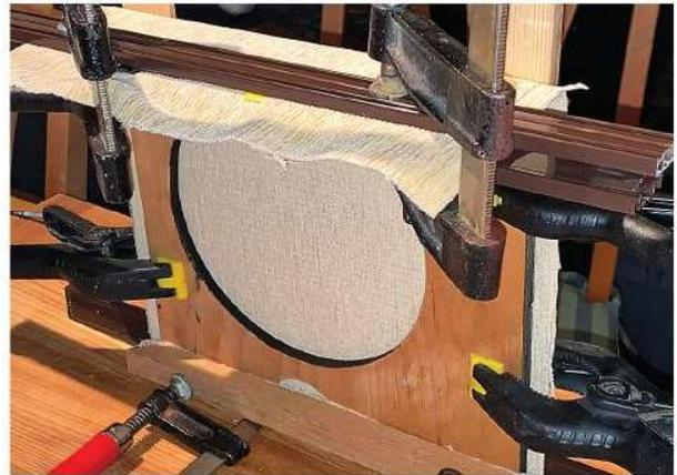
In der Regel wird ein Stoff mit einem transparenten Kleber an die Schallwand angeklebt. Der Bastler, wie bereits oben erwähnt, hat sich hier vor Jahren einmal mit einem beidseitigen Klebeband geholfen, um dieses graue stoffähnliche Netz aufzukleben. Dieses war sogleich entfernt und die Schallwand in dunklem Ton nachlackiert und ausgebessert.
