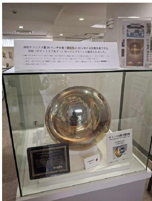
ニュートリノを観測するためにカミオカンデに使われている 20 インチの光電子倍増管
